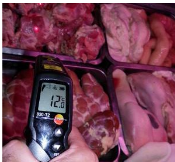
X Temperatura de refrigeración en una cámara de exhibición: 12° C
