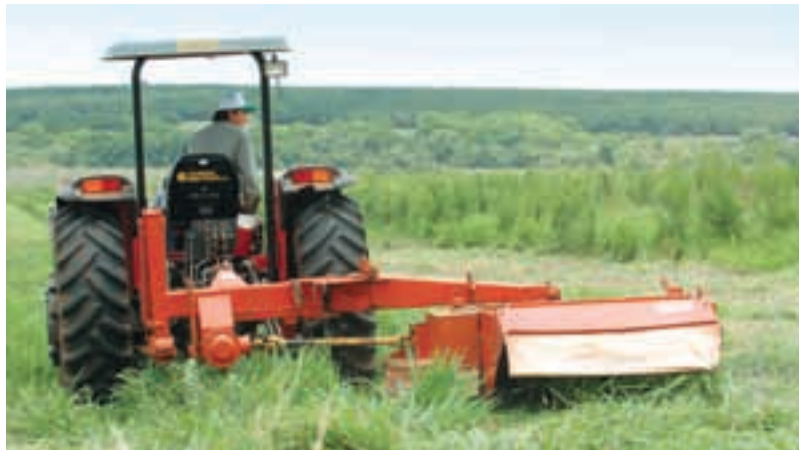
Segadora deshidratadora en plena tarea. Confección de rollos a partir de una pradera de braquiaria.
